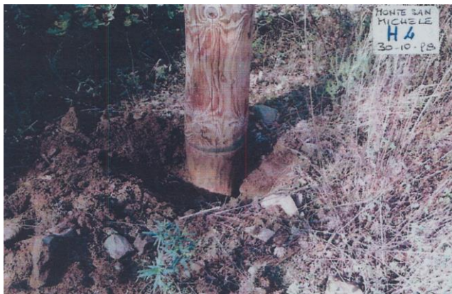
drog impregniran s Tanalith – E po 6 letih (Italija)
